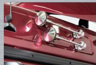
Un vigoroso sound a 2 tonalità: potente dispositivo di avvertimento acustico in acciaio inox.
